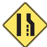
Конец полосы: перестроиться влево
